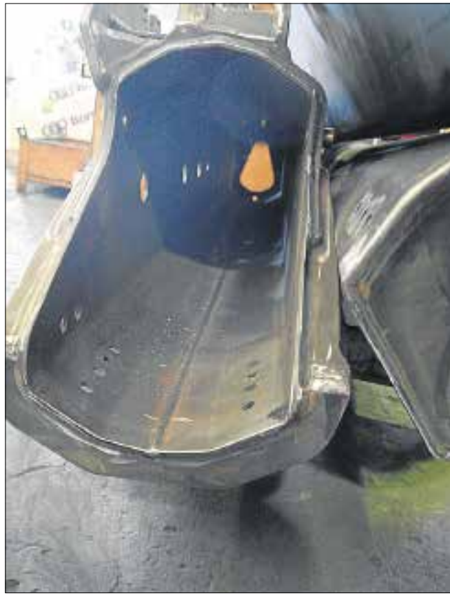
Der er udviklet en helt speciel svejseteknik, så man kan hæfte kranarmens samling sammen. Svejsningen foretages både indvendigt og udvendigt på samme tid.
