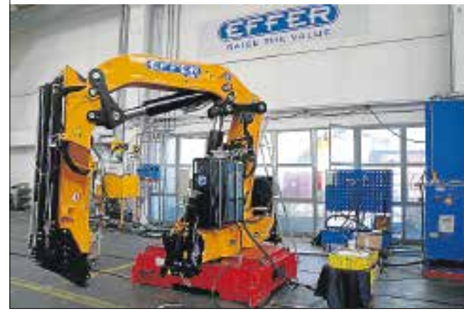
Kranen er nu bygget færdig. Her skal de forskellige funktioner testes, inden den går videre til afsendelse.
