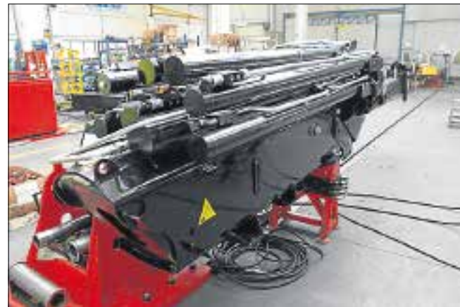
Når der som her er ny hydrauliske udskud, skal der være plads til alle cylindrene og hydraulikrørene.
