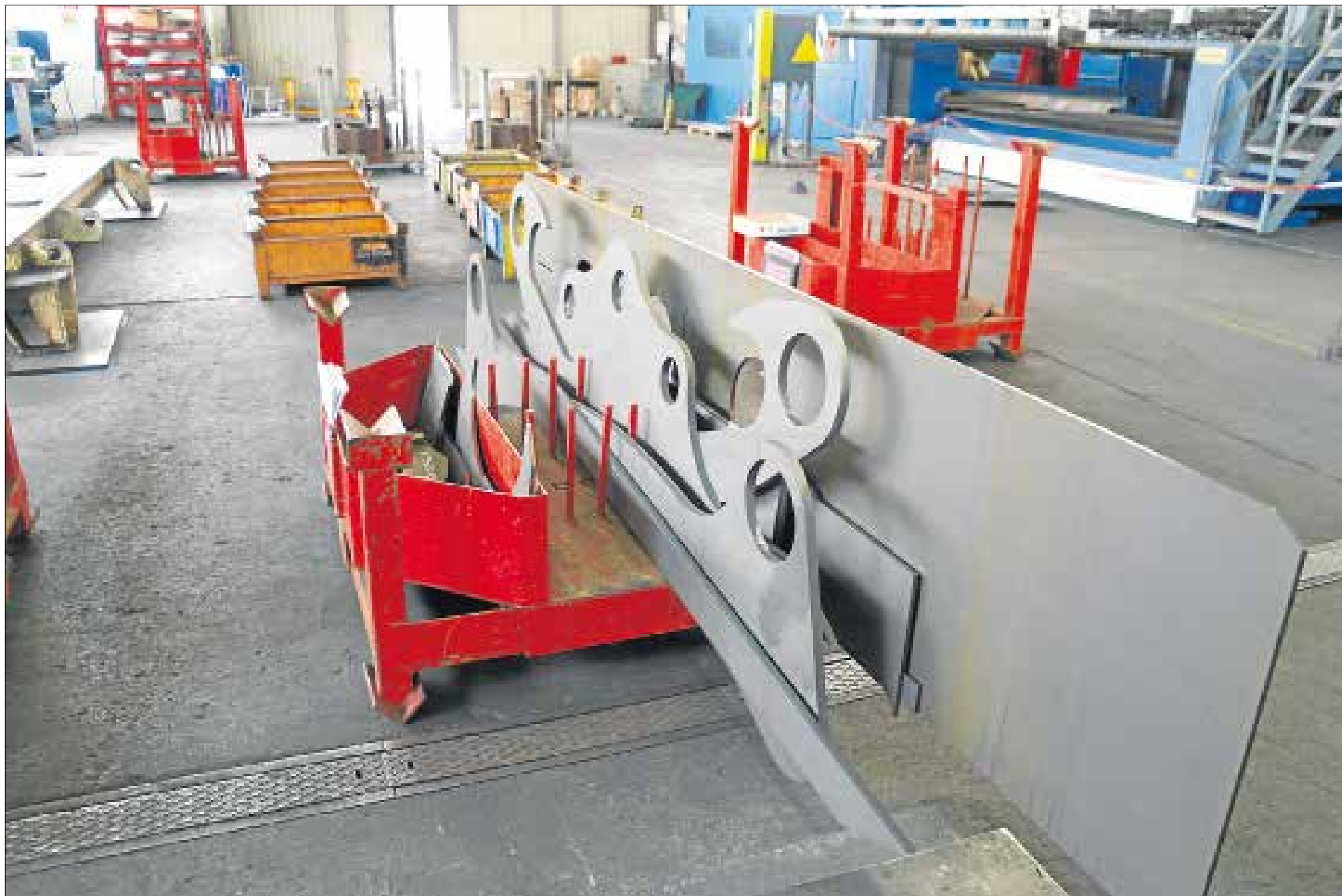
Det ser ikke ud af meget, men her står de forskellige stålplader og udskæringer, som udgør en kran. Pladerne er lige kommet ud af laserskæreren.
