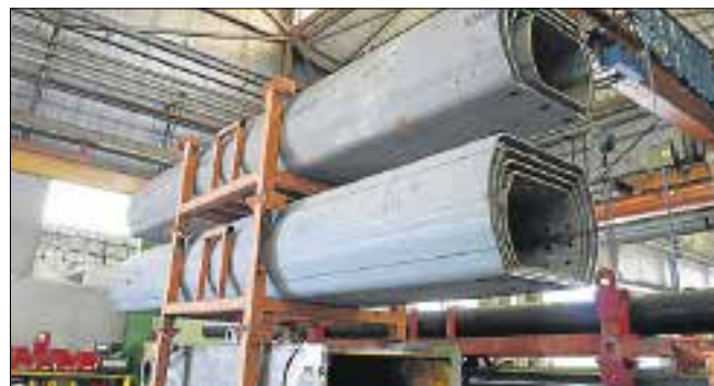
Effer har taget patent på det 10-kantede design af kranarme, der bukket af et enkelt stykke stålplade. Denne form gør, at man kan reducere stålpladens tykkelse og vægt.
